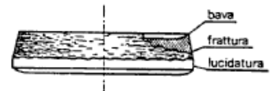
9.16 - Successione delle varie fasi in un processo di tranciatura.
